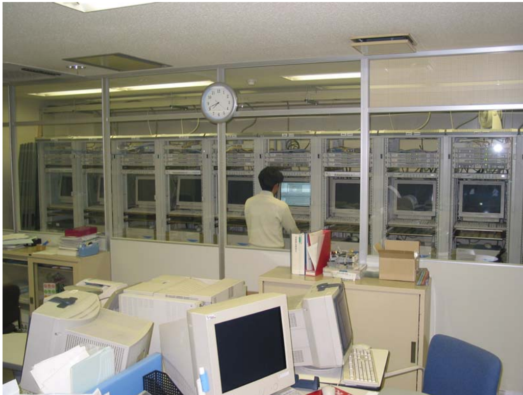
Figura 16: Servidores centrales de la red JENOBA VRS de Japón gestionada por Trimble GPSNet
