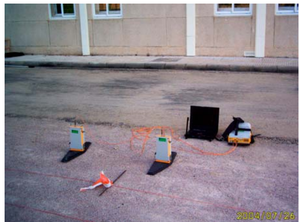
Foto 8. Toma datos CMP con antena biestática no apantallada 200MHz
