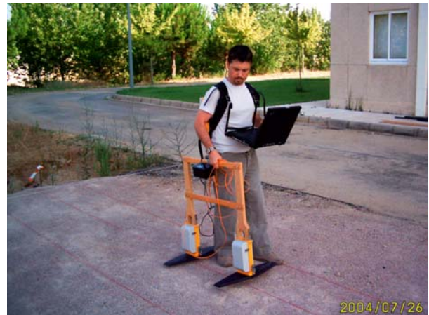
Foto 7. Toma de perfiles con antena biest. no apant. 200MHz
