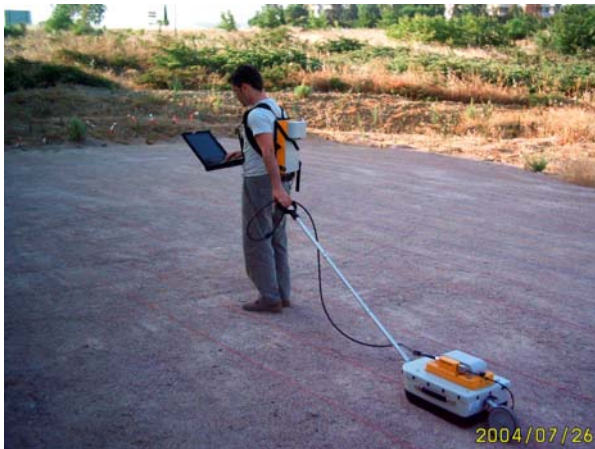
Foto 6. Toma de perfiles con ant. Monoest. Apant. 500MHz
